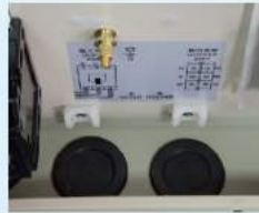
I/P & O/P Wires Protection
